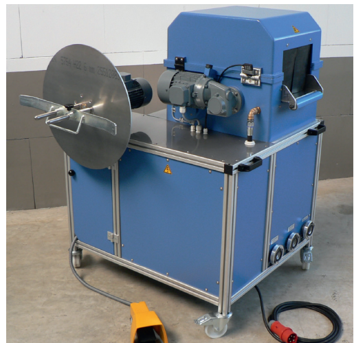
Enrouleur latéral à côté de l'unité d'entretien des tuyaux pour un enroulement simple ou double des tuyaux. Commande par pédale.
