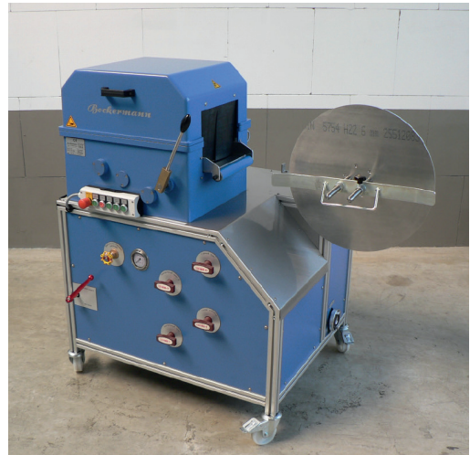
Enrouleur en version pivotante pour une opération simultanée de lavage et d'enroulement
