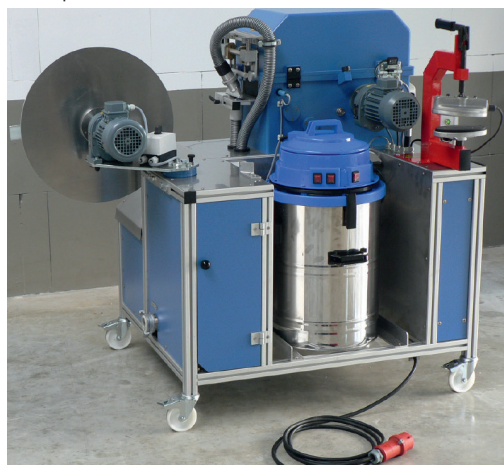
Enrouleuse en version flottante pour le lavage et l'enroulement simultanés ou tournée latéralement à côté du SPZ pour l'enroulement d'un ou deux tuyaux. Commande par pédale.
