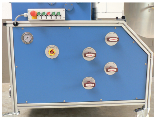
Installation de contrôle de pression avec tableau de commande claire et simple
