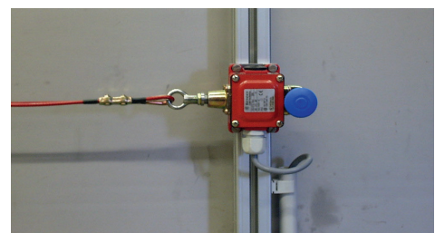
Cordon d'arrêt d'urgence conforme à la directive européenne sur les machines
