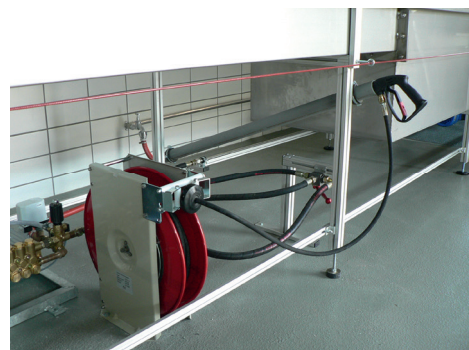
Lance de nettoyage avec support et tuyau sous le plateau d'entretien SPW-H
