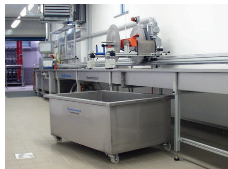
Réservoir de récupération de l'eau de test en acier inoxydable (capacité 500l)
