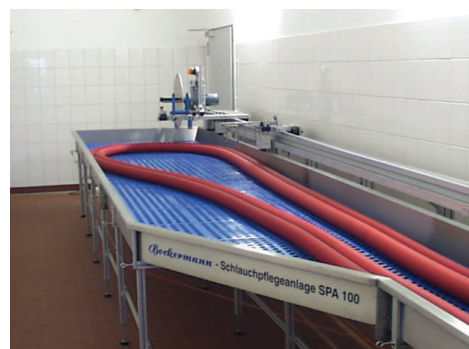
Grilles en plastique dans un SPW-H
