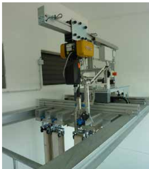
SBA avec double support de suspension pour tous les systèmes d'accouplement. illustration d'une fixation sur rail d'une capacité de 100 tuyaux.
