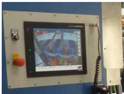
Panneau de commande avec écran tactile et surveillance vidéo intégrée de toutes les fonctions
