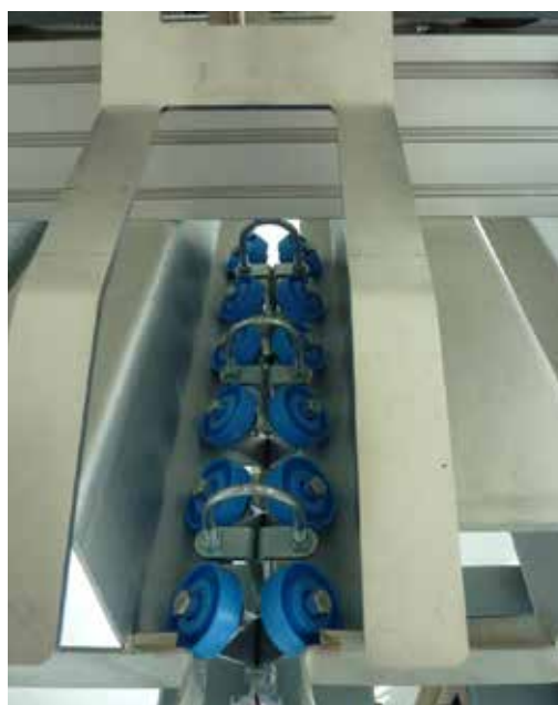
Quatre roulettes à roulement à billes assurent un guidage optimal des adaptateurs dans les rails du tuyau.
