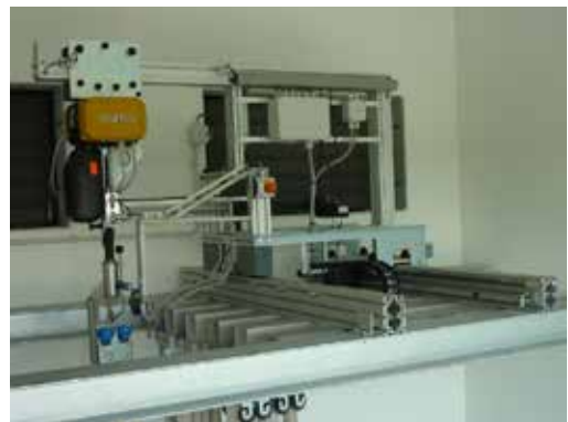
SBA avec palan à chaîne et convoyeurs aériens en acier inoxydable
