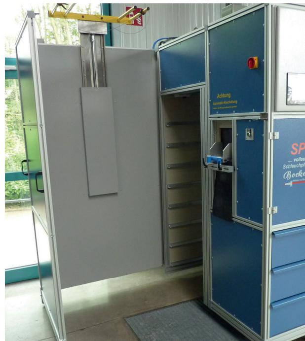
Système d'entretien CSA pour la combinaison de protection lorsqu'elle est retirée, dispositif de levage de la combinaison au-dessus.
