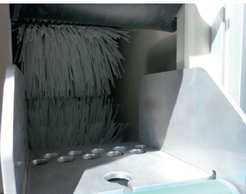
Laveuse de tuyaux haute pression à brosse avec alimentation automatique des tuyaux
