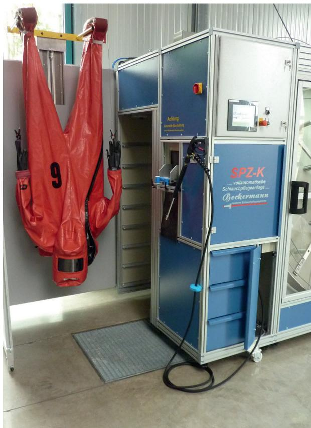
Pistolet de nettoyage à haute pression avec régulateur de pression et système d'enroulement automatique du tuyau
