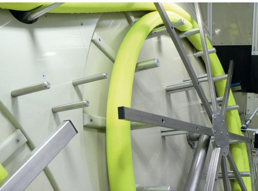
**Exemple :** protection optimale contre l'éclatement entre les disques de la bobine avec un dispositif de protection contre l'éclatement en forme d'étoile
